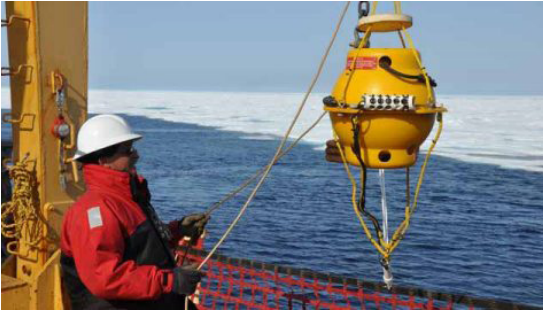
Dispositivo de análisis acústico utilizado por el programa Bioacoustics Research Program (BRP) para recopilar datos de grandes ballenas barbadas y otros mamíferos marinos. Foto cortesía de Dimitri Ponirakis.
